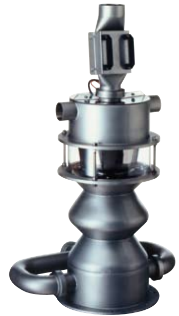
Kaskadenwindsichter mit integriertem Metallabscheider und Ionisator. Durch die spezielle Konstruktion werden an der Oberfläche des Granulatkörnchens anhaftende Feinstaub- und Fremdpartikel zuverlässig vom Rohstoff getrennt. Einer der entscheidenden Bausteine zur zuverlässigen Vermeidung von Verunreinigungen.
