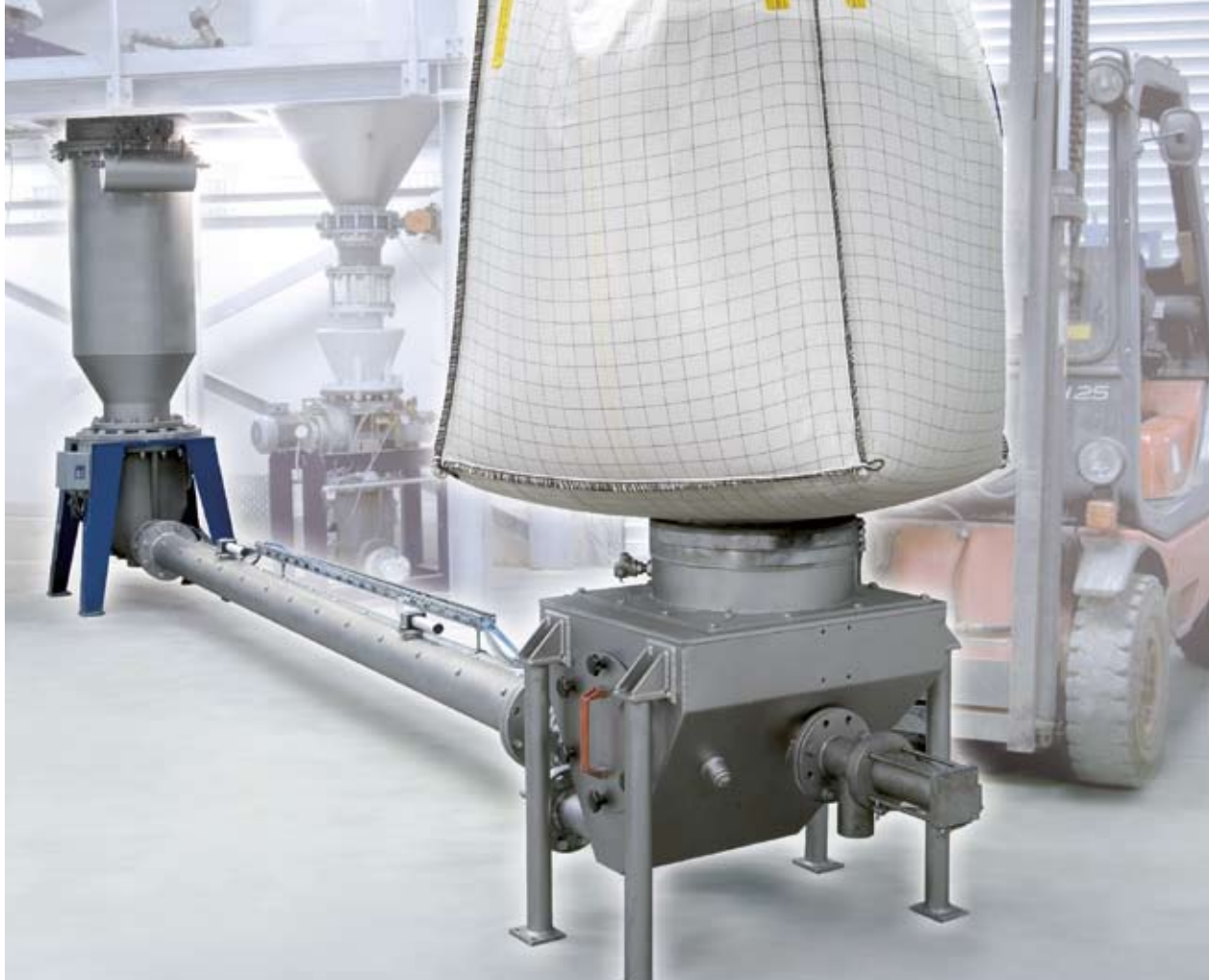
Demonstrationsanlage im Technikum. Rechts Schüttgut-aufgabe mit Big Bag, links Pump-Flow-Sendestation. Maximale För-
