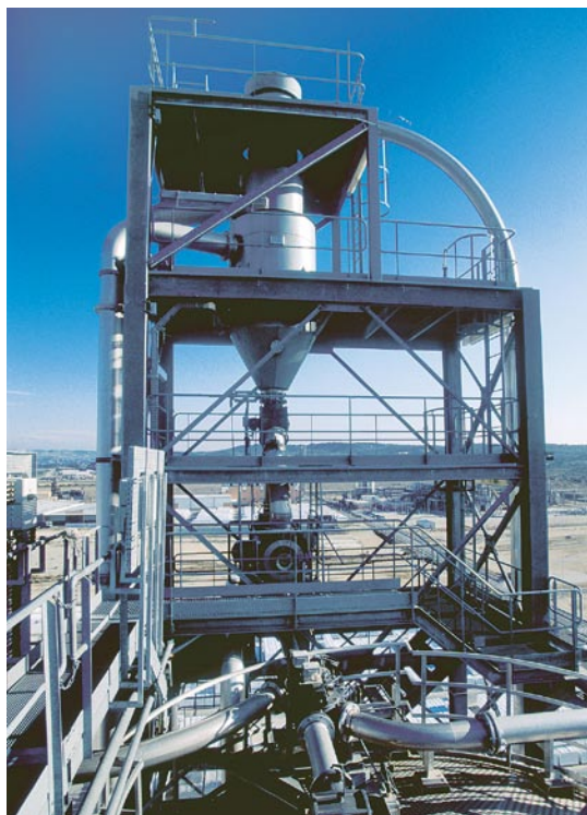
Innovative Technologie zur Produktreinigung: Vom Trommelsieb über den Sichter bis zum Zyklon.
